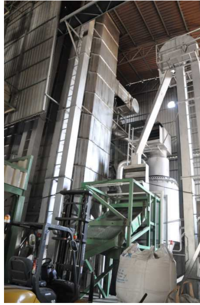
โรงงานอบลดความชื้น กำลังการผลิต 160 ตัน/วัน ที่ ภาควิชาวิทยาศาสตร์และเทคโนโลยีสนับสนุนงบประมาณในการจัดสร้าง
