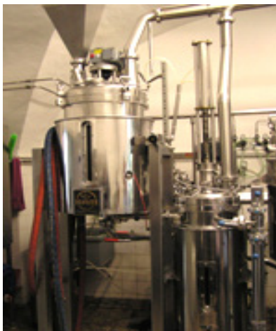
ภาพที่ 1 หม้อต้มสกัดน้ำหวานในระบบ microbrewery (ณ สถาบัน Institute of Brewing Technology I/Weihenstephan, Freising, Germany) ที่มา: โชคชัย วนภู, 2549
